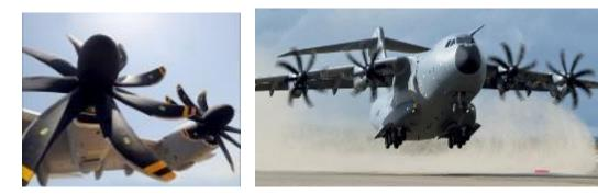
A400M Propeller: dia ≈ 5,3 m / 8 blades
