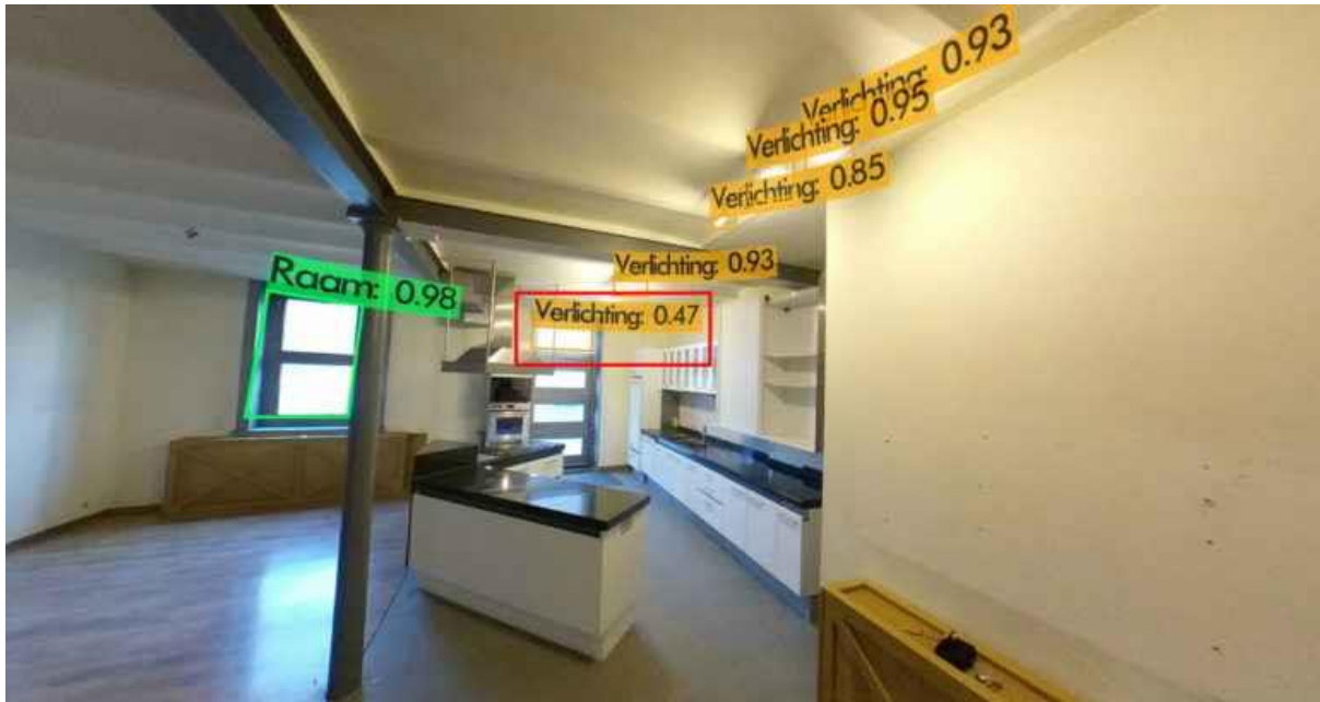
Foto van een open keuken met daarin herkenningen van verlichting en ramen. Een rood kader geeft een klein raam aan dat foutief is herkend als verlichting
