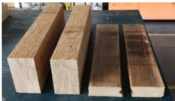
Fig. 1 – Sections de bois de pruche avant et après densification de 400 kg/m 3 à 1400 kg/m 3 [U Liverpool].
