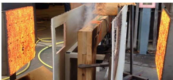
Fig. 13 - Assemblage tourillonné soumis au feu [U Lorraine].
