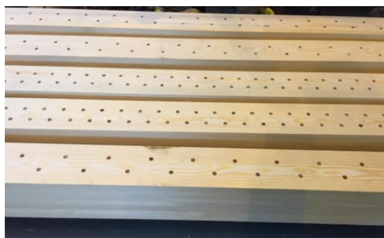
Fig. 3 - Poutres lamellées tourillonnées [U Liverpool].
