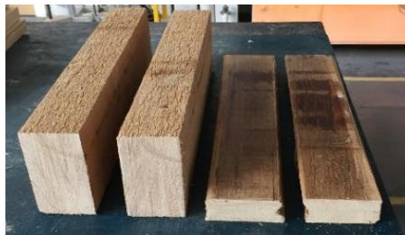
Abb. 1 – Holzprofile aus Hemlocktanne vor und nach dem Verdichten von 400 kg/m 3 auf 1400 kg/m 3 [U Liverpool].
