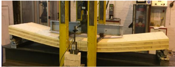
Abb. 4 – Untersuchungen an gedübelten Deckenplatten [U Liverpool].
