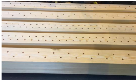
Abb. 3 – AF Brettschichtholzträger mit Dübel [U Liverpool].
