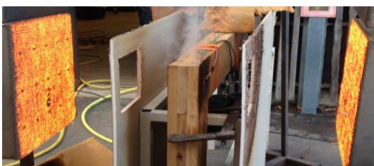
Abb. 13 - An AF-Verbindung durchgeführter Brandversuch [U Lorraine].
