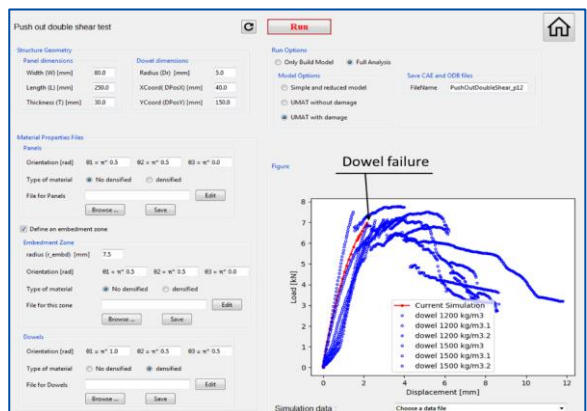
Abb. 11 - Benutzerschnittstelle der numerischen Ergebnisse eines Doppelschubversuchs [Luxembourg IST].
